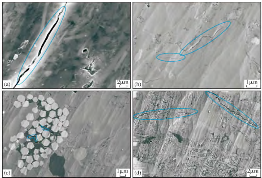
图3 长7段页岩中不同类型微裂缝发育
